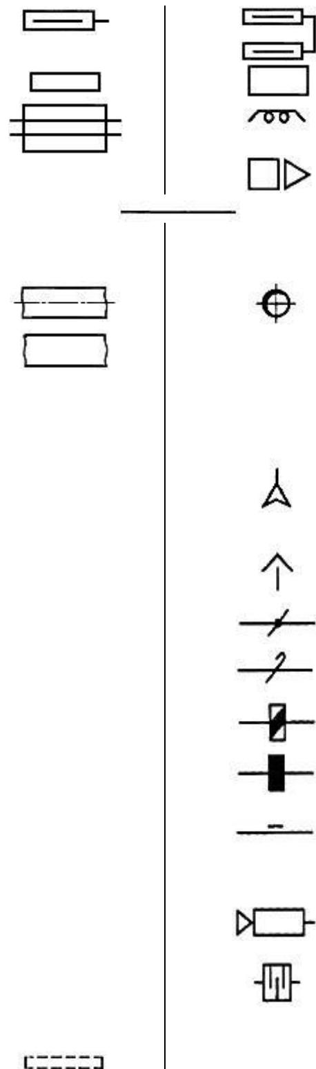
\* В обозначении на видах, разрезах и схемах указывают графически действительное количество труб.
